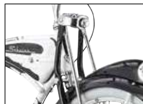
サスペンションとして機能するSCHWINN クラシック スプリングアー サスペンション フォーク。
